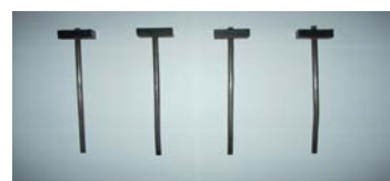
Gambar 3.3 mild steel dengan panjang 30 cm, diameter 8 mm
