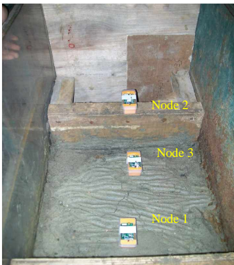
Gambar 7. Persebaran Node Pada Shaking Table.
